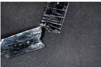
Spatola fratturata per corrosione ed
