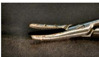
*Corrosione perforante su di uno strumento per uso odontoiatrico. Causa: elevato contenuto di cloro nell'acqua*
