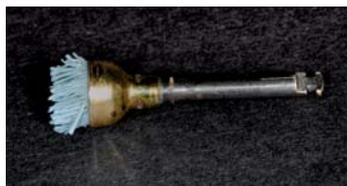
*Trascolorazione per presenza di metalli diversi su di un unico strumento*
