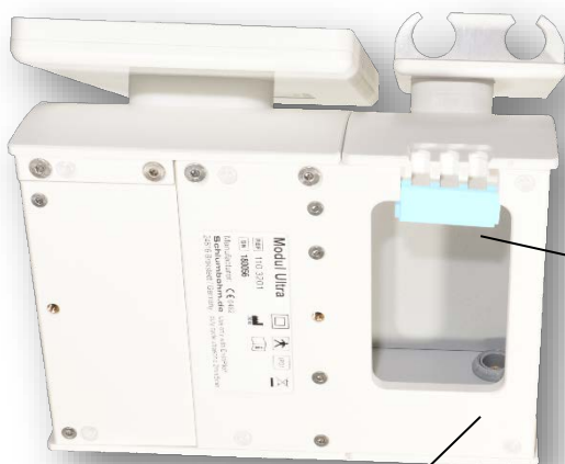
Imagen 16 a Módulo de ultrasonidos Compartimento inferior con conexión para el cable de ultrasonidos
